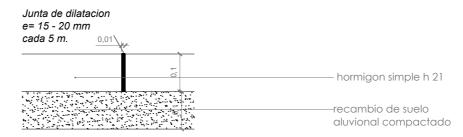
Relleno con material compresible tipo mastic asfaltico.
