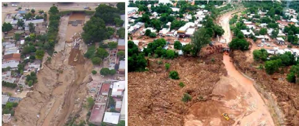
**Figura 41.** Imagen del daño ocasionado por la crecida del río Tartagal en el año 2006.
