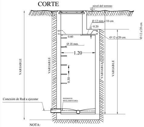
Para alturas igual o menores de 2.00 mts. el espesor de hormigón es de 0,15 mts. Para alturas mayores de 2.00 mts. el espesor de hormig;on es de 0,20 mts.
