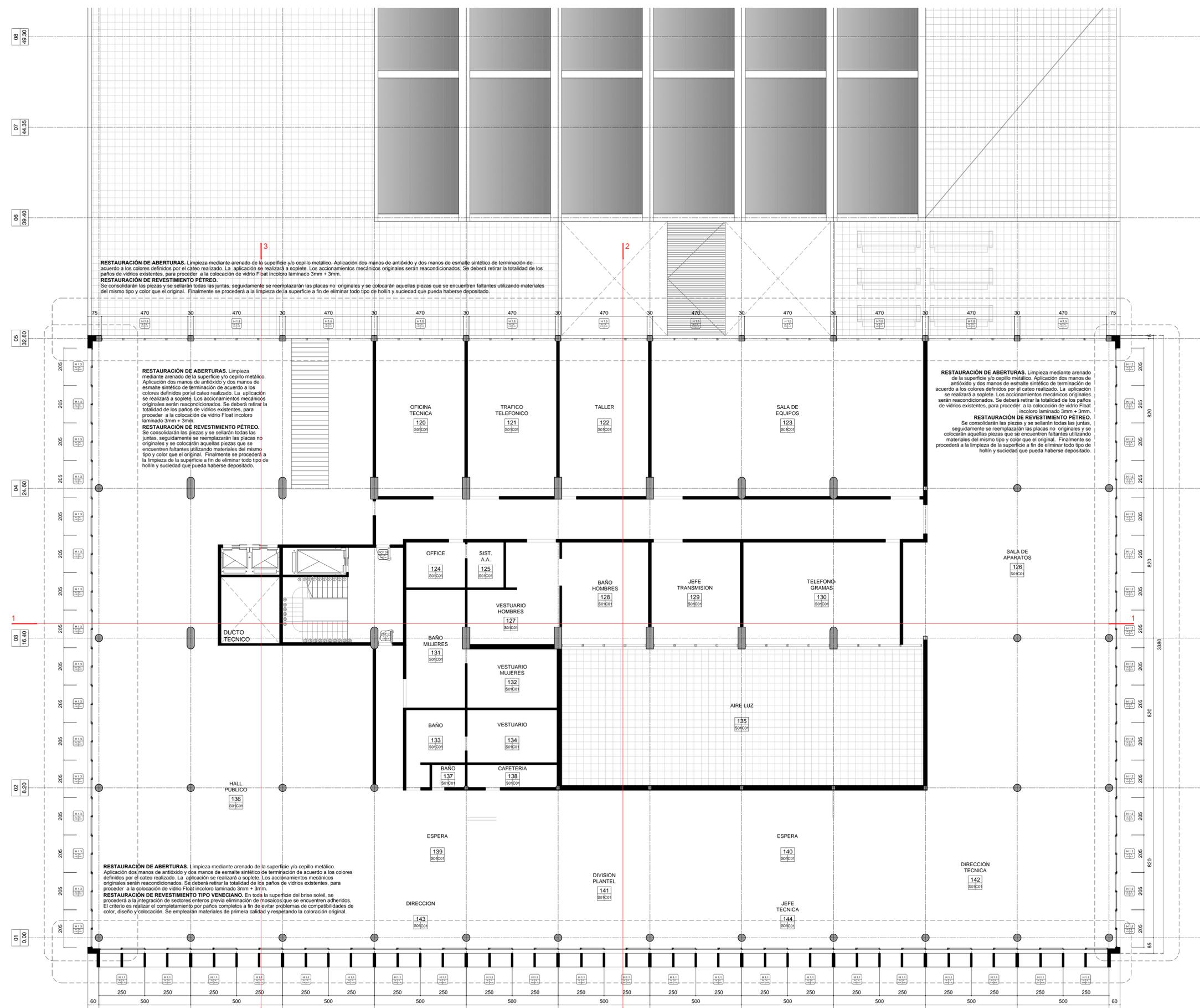
**RESTAURACIÓN DE ABERTURAS.** Limpieza mediante arenado de la superficie y/o cepillo metálico. Aplicación dos manos de antioxido y dos manos de esmalte sintético de terminación de acuerdo a los colores definidos por el cateo realizado. La aplicación se realizará a soplete. Los accionamientos mecánicos originales serán reacondicionados. Se deberá retirar la totalidad de los paños de vidrios existentes, para proceder a la colocación de vidrio Float incoloro laminado 3mm + 3mm.
