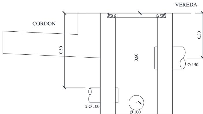
**NOTA :** TODOS LOS ORIFICIOS PROVISTOS DEBERÁN SER PASANTES EN LA PARED DE HORMIGON DE LA CAJA
