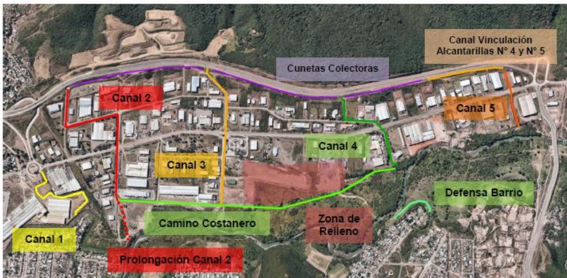
Ilustración 3: Disposición General del Sistema de Desagües del Parque (Sin red Interna de Cuentas)
