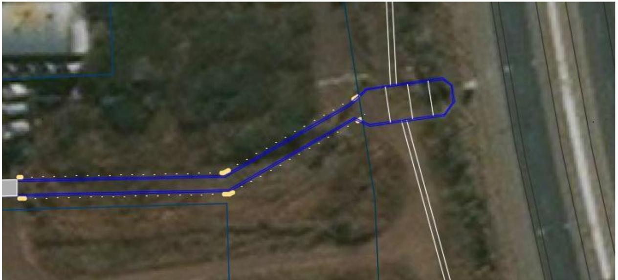
**Ilustración 22: Obras de Vinculación Alcantarilla N° 3 (Existente) y Canal N° 4**
