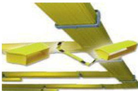
Ejemplo de bandejas para transporte exclusivo de cables de fibra óptica en los nodos.
